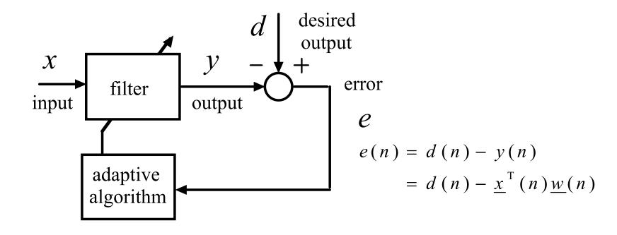
$e^{2}(n) = d^{2}(n) - 2d(n)\underline{x}^{T}(n)\underline{w}(n) + \underline{w}^{T}(n)\underline{x}(n)\underline{x}^{T}(n)\underline{w}(n)$
