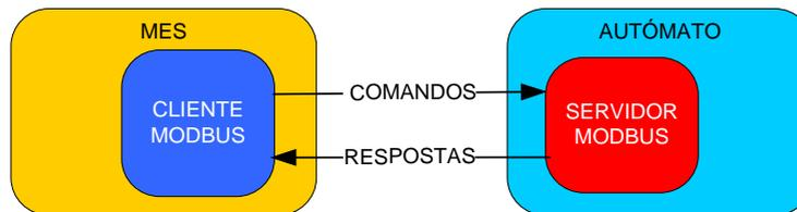
Os pedidos estão organizados sob a forma de **comandos**. Cada comando tem uma estrutura específica e representa uma ação que deve ser realizada pelo autômato (ex. retirar uma peça do armazém). Quando é enviado um comando para o servidor este gera uma **resposta** que indica a forma como o comando foi executado.
